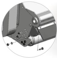
Регулируемый капот устанавливает степень измельчения материала
