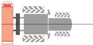
Гидравлический линейный сдвиг
