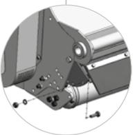
Регулируемый капот устанавливает степень измельчения материала
