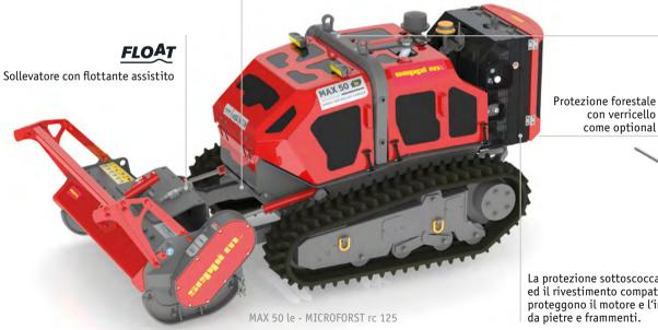
La protezione sottoscocca ed il rivestimento compatto proteggono il motore e l'impianto da pietre e frammenti.
