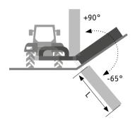
La trincia può essere inclinato di 90° verso l'alto e inclinato di 65° verso il basso
