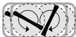
Lames superposées pour une coupe régulière, même si on varie la largeur de travail.
