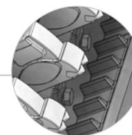
Contre-couteaux à l'intérieur du châssis pour augmenter la finesse de broyage
