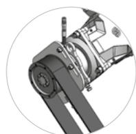
Courroies en CARBONCHAIN assure une grande robustesse et une forte stabilité de longueur avec en augmentant la flexibilité
