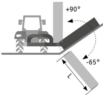
La trituradora se puede inclinar 90° hacia arriba y 65° para estar inclinado
