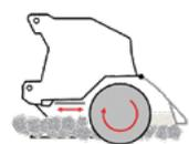
Barra de trituración regulable para ajustar el grado de trituración
