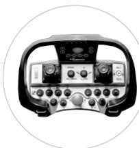
Eine Besonderheit ist die Funksteuerung, die mit einem grafischen Display ausgestattet ist, welches alle Funktionen und Störungen überwacht. Der Frequenzbereich beträgt 2,4 GHz und deckt Entfernungen von bis zu 160 m ab.
