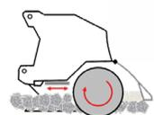
Einstellbare Brechleiste bestimmt den Zerkleinerungsgrad der Steine
